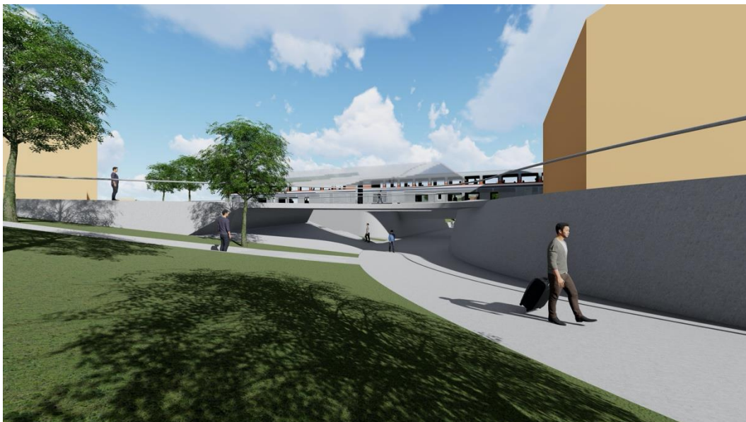
Figur 6-11 Rampe ned mot kulvert, -gangforbindelse over rampe til plattform. Stasjonsbygg oppe til høyre
